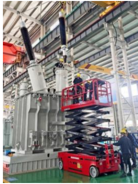
Proceso de pruebas e inspección Transformador de potencia 75 MVA, Ecuador
